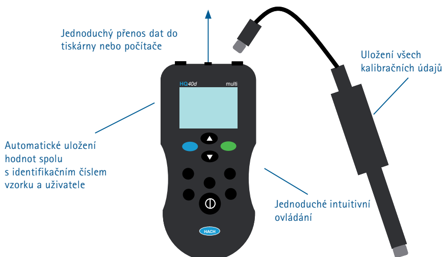
Obr. 1: Přístroj HQD a základní funkce (schematicky).
