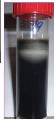
Obr. 1 Ilustrační schéma interpretace úrovně kontaminace železitými bakterie. Příklady barevné reakce testu dle úrovně kontaminace. Vzorky byly odebrány při odkalování vodovodního řadu.
