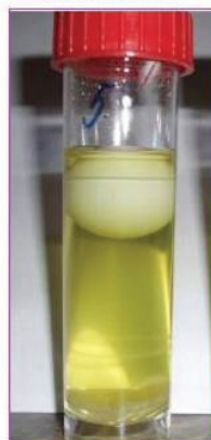
Obr. 1 Ilustrační schéma interpretace úrovně kontaminace železitými bakterie. Příklady barevné reakce testu dle úrovně kontaminace. Vzorky byly odebrány při odkalování vodovodního řadu.
